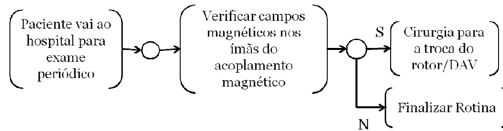
Figura 28 - Tratamento da falha "Desalinhamento do Rotor Causando Desacoplamento Magnético".
